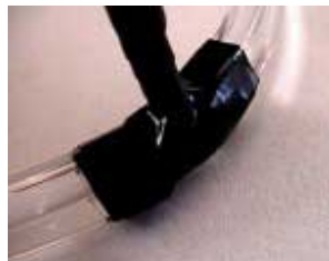
Fita isolante segurando e protegendo os LEDs
