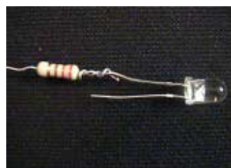
Resistor conectado ao positivo do LED.
